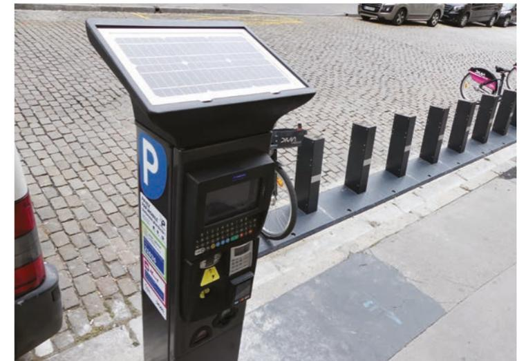
**Die Parkautomaten mit aufgesetzten Solarzellen sind autark und brauchen keinen Strom- oder Netzwerkanschluss.**
